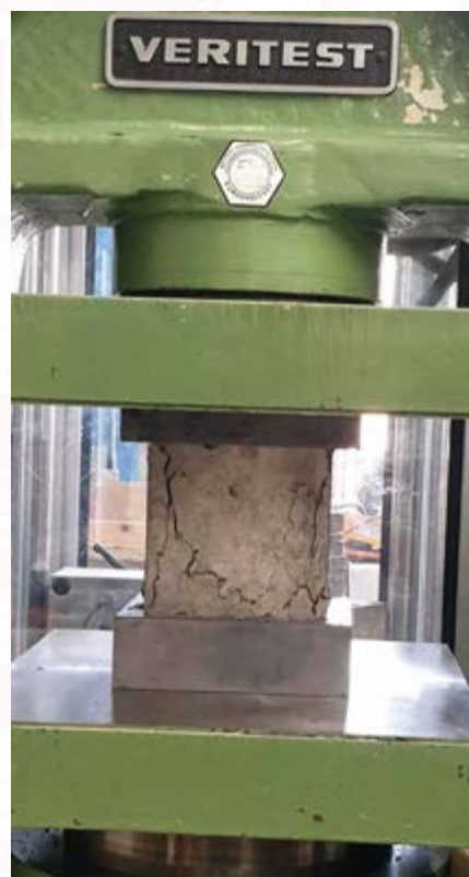
Beton im Prüftest
